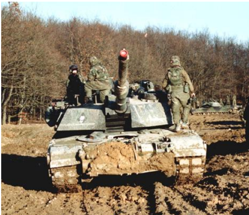
Bei diesem stark verdreckten und kaum zu erkennenden Anbau an der Frontplatte handelt es sich um eine Adapterplatte für einen Mienenroller. Leider waren diese während der Übung nicht im Einsatz (Philipp Zimmer)
