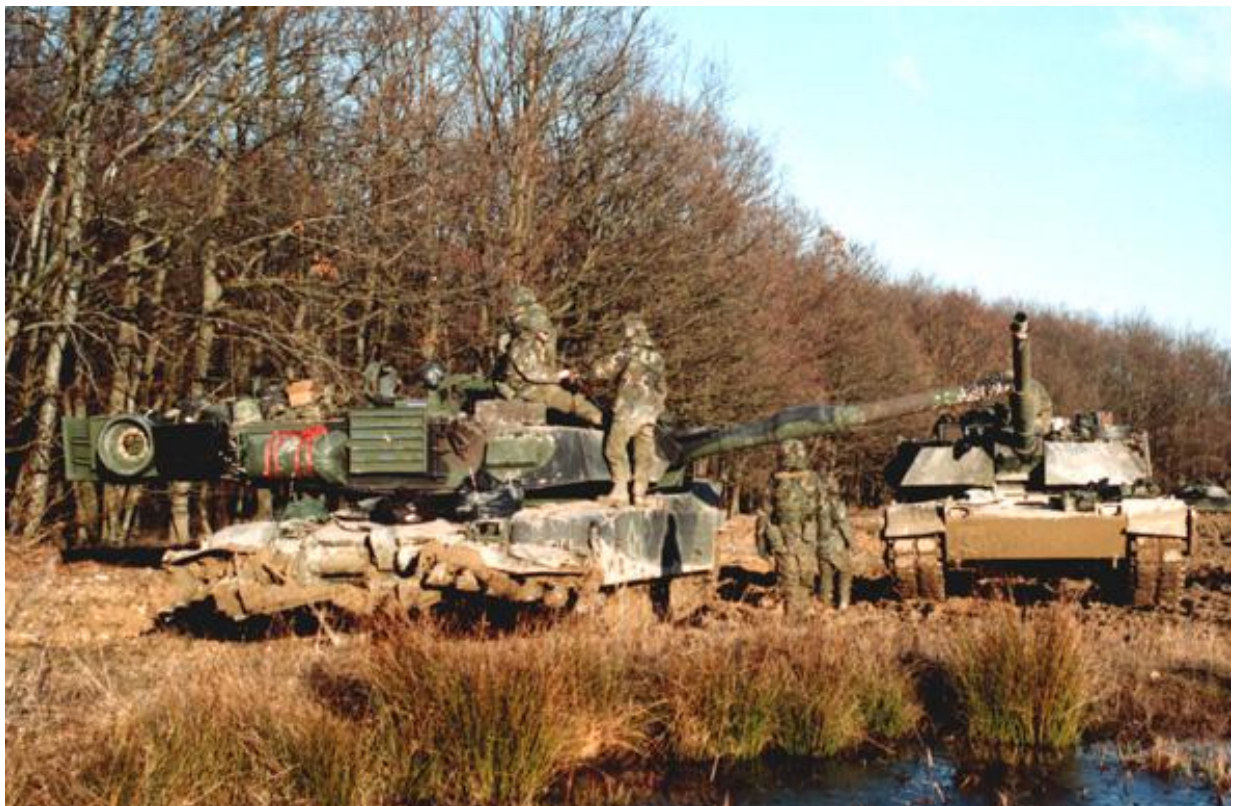
Hier stehen zwei M1A1 eines Platoons (Zug) zusammen vor einem Tümpel. Das rechte fahrzeug hat einen Mieneflug installiert (Philipp Zimmer)
