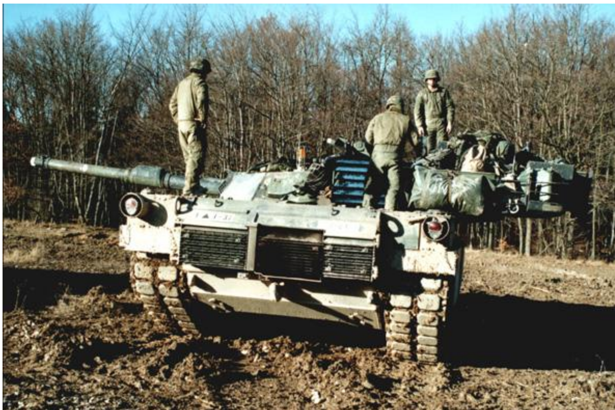
Heckansicht eines Abrams Kampfpanzer, dieser besitzt noch die alte Auspuffabdeckung (Philipp Zimmer)
